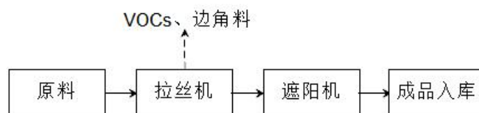
图 2-5 遮阳网生产工艺流程简图
